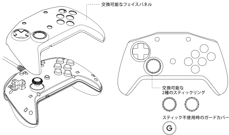
交換可能なガードカバーの装着方法
