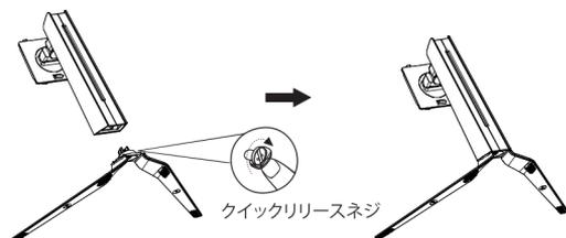
3. 下図のように、組み立てたスタンドシステムを背面開口部の挿入口に挿入し、スタンドシステムブラケット部を軽く押しつけてロックします。ロックしていることを確認してください。
