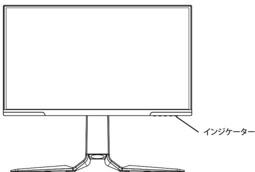
インジケータ: 青色の点灯は電源がオンでモニターが正常に動作していることを示します。
